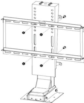
8. Collegare il support TV 4a o 4b la staffa 2. Here foQui per l'uso 4 delle viti a testa tonda M8x16 11 e I 4 dadi autobloccanti 12.
